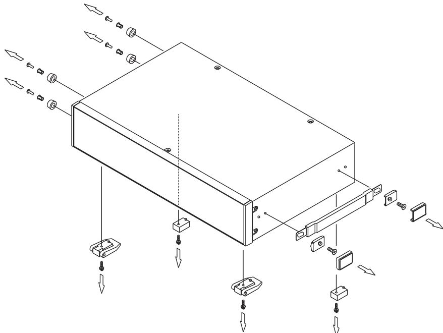
2. 付属しているねじを使用してブラケットを図のように取り付けます。
